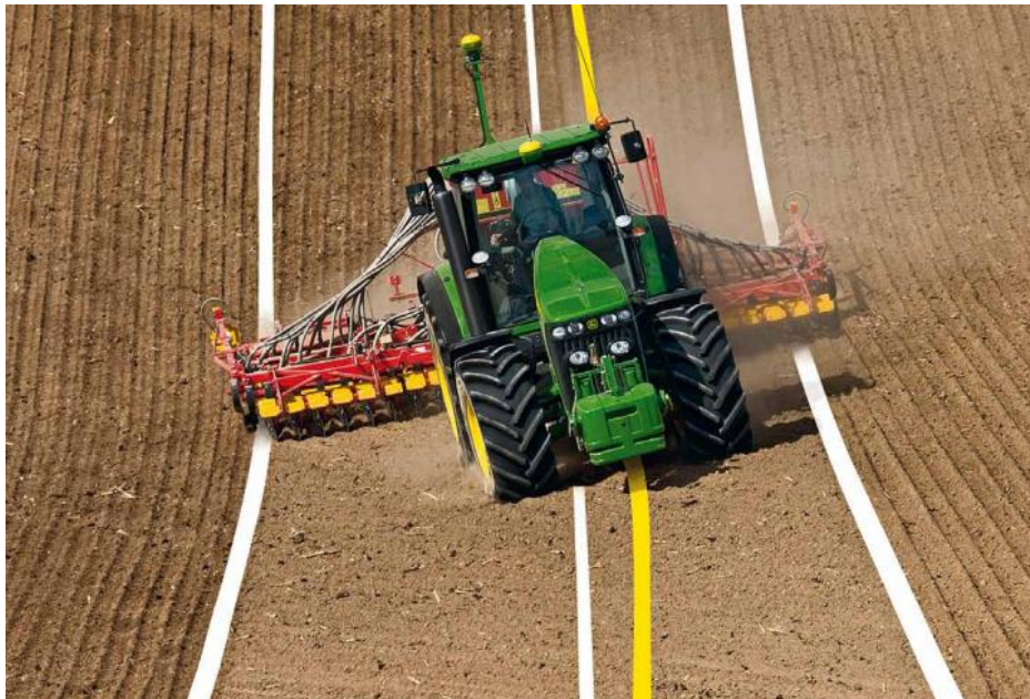
Slika 1.23. Prikaz vođenja agregata na nagnutom terenu
